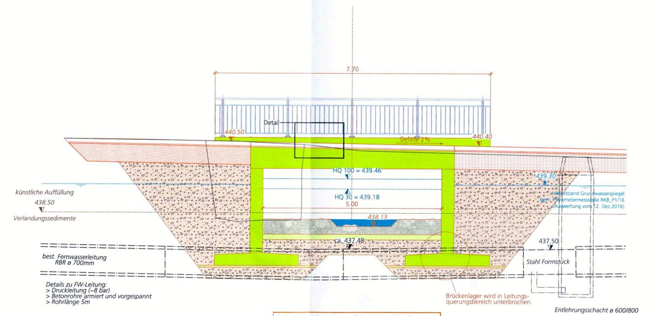
Bodenplatte oder Kastenprofil (evtl. mit Sohlenplästerung) zum Schutz der FW-Leitung, damit keine Lasten direkt auf das Rohr einwirken. Leitung vor Vibrationen und Schlägen schützen.
