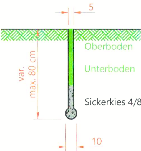
Querschnitt 1:20 Detail Schlitzdrainage
