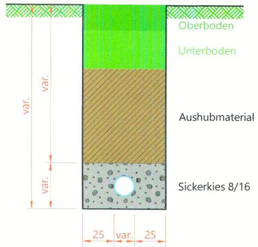
Querschnitt 1:20 Detail Sammelleitung Fräsen
