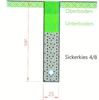
Querschnitt 1:20 Detail Sammelleitung
