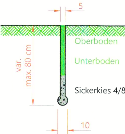
Querschnitt 1:20 Detail Schlitzdrainage
