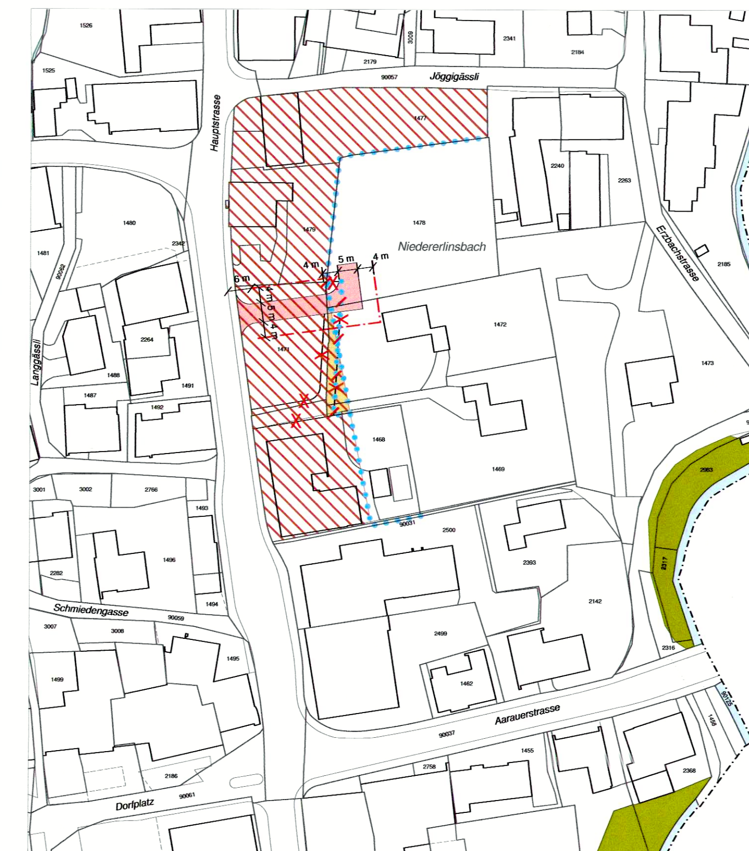
Änderung Bauzonen- und Erschliessungsplan (Genehmigungsinhalt)
