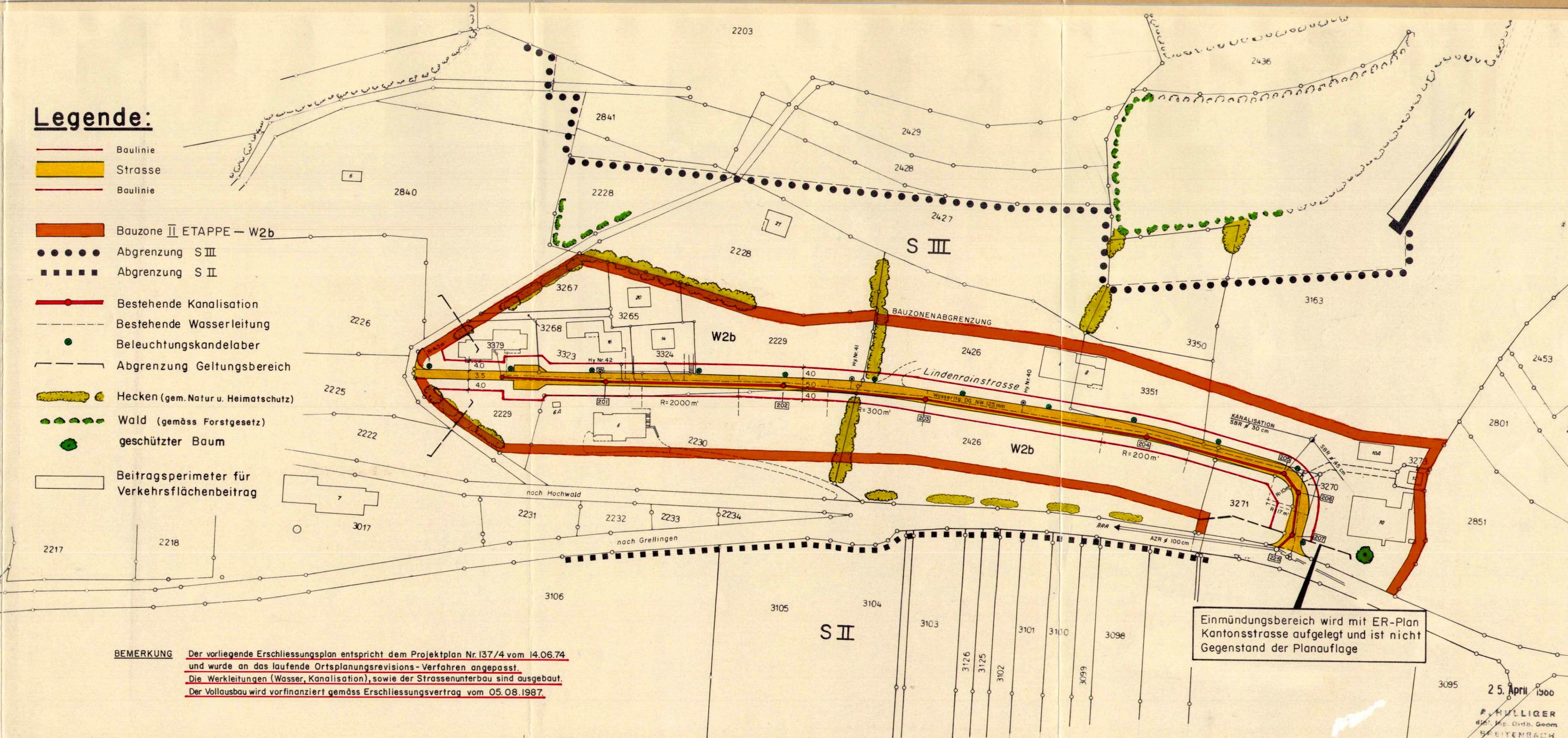
**BEMERKUNG** Der vorliegende Erschliessungsplan entspricht dem Projektplan Nr. 137/4 vom 14.06.74 und wurde an das laufende Ortsplanungsrevisions-Verfahren angepasst. Die Werkleitungen (Wasser, Kanalisation), sowie der Strassenunterbau sind ausgebaut. Der Vollausbau wird vorfinanziert gemäss Erschliessungsvertrag vom 05.08.1987.
